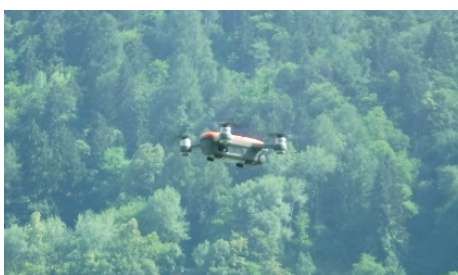
Figura 3 – SAPR DJI SPARK ad ala rotante con videocamera integrata
