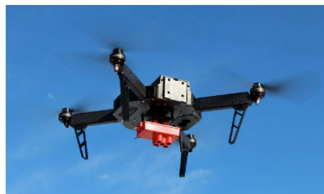
Figura 2 – SAPR Q4E ad ala rotante su cui è montata la camera multispettrale
