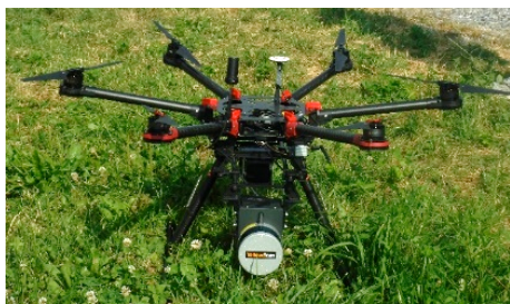
Figura 1 – SAPR DJI S900 ad ala rotante su cui è montato il sensore LiDAR
