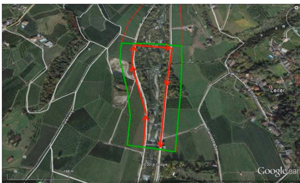
Figura 12 – Piano di volo con LiDAR, rilievo sulle sponde
